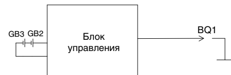
Цепь зажигания BOGH-15E
