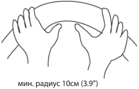
Согните трубу при помощи больших пальцев
